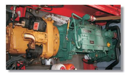
变速箱与变矩器:采用美国DANA公司产品(原CLARK变速箱),该变速箱采用多种控制程序集成于一体控制部件,能轻易 实现各种控制操纵,并带有故障诊断仪,大大简化了维护与保养。变矩器最大变矩比为2.13,高效范围宽,油耗少。
