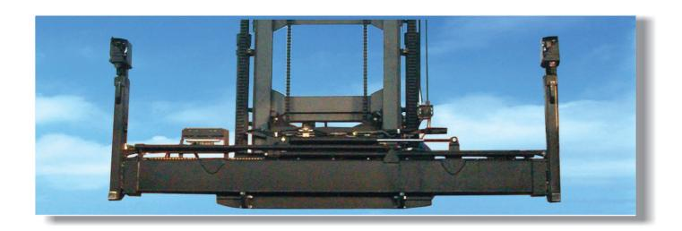
吊具:采用瑞典ELME公司的新型吊具,该吊具采用优质钢制造,单筒式结构,强度高,视野好,带安全互锁功能。可实现侧移、伸缩和开闭锁等动作,并有吊具状态指示,辅助灯光照明等功能。
