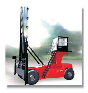
设计手段:在整机的研制过程中借助计算机技术,运用了最新的设计方法和手段;车架、门架等关键结构件均经CAE有限元分析、模态分析、动力学仿真分析等优化设计手段,以精准的理论数据支持为设计基础,确保整车稳定性和结构强度均符合欧盟设计标准。
